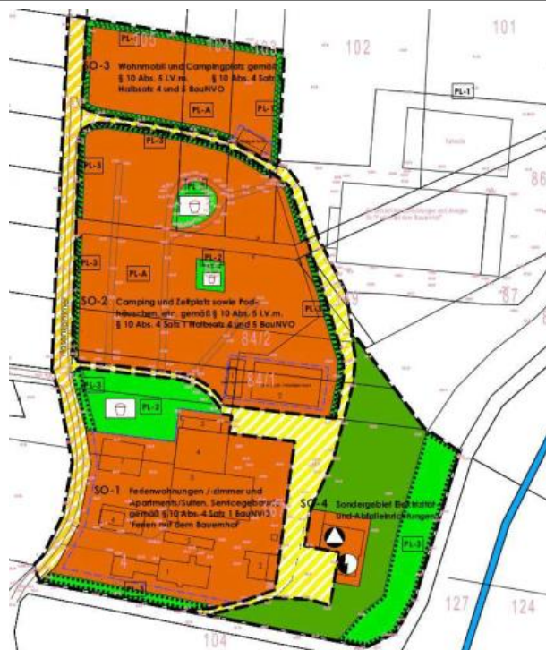
Abb. 29 - Entwurf des Bebauungsplanes Nr. 40 mit den festgesetzten/zu erhaltenden Saum-, Grün- und Pflanzstreifen
